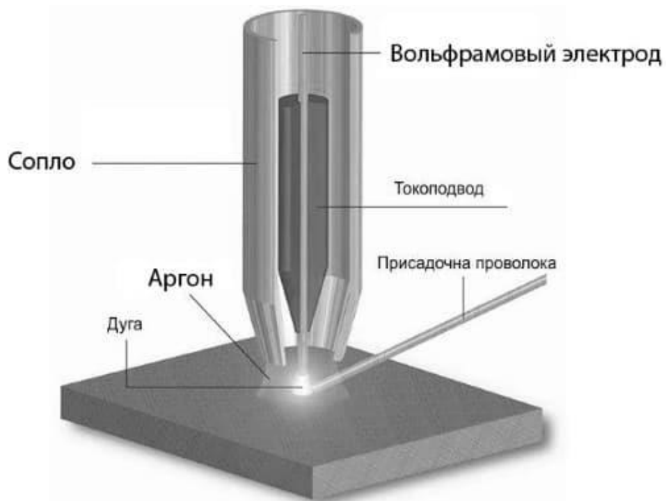
Рис. 5.4. Устройство горелки аргонодугового сварочного аппарата
