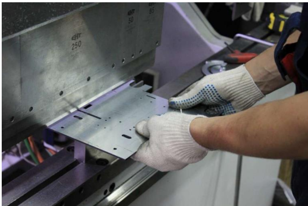
Рис. 4.5. Радиус сгиба должен превышать толщину профиля или детали в 25 раз
