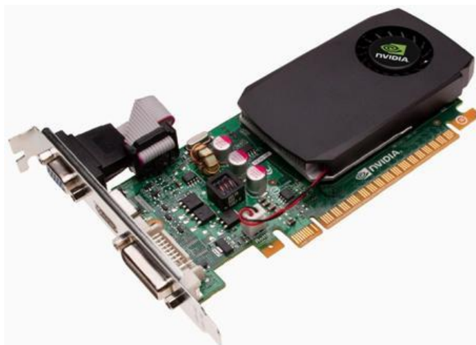
Рис. 1.12. Видеоадаптер (видеокарта) от NVIDIA
