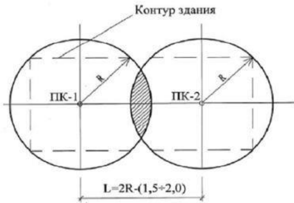
Рис.13. Схема размещения пожарных кранов
