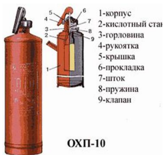
Рис.21. Химический пенный огнетушитель ОХП-10
