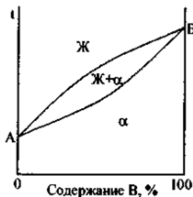
Рис. 1.27. Диаграмма состояния сплавов с неограниченной растворимостью
