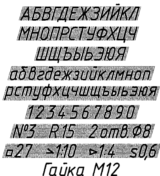
Рис. 1.5. Шрифт чертежный типа Б с наклоном около 75° (ГОСТ 2.304-81*)
